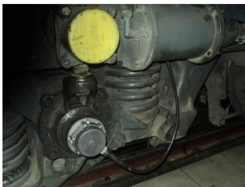
Сурет 2.8 – 2ТЭ10МК тепловозына орнатылған одометр
