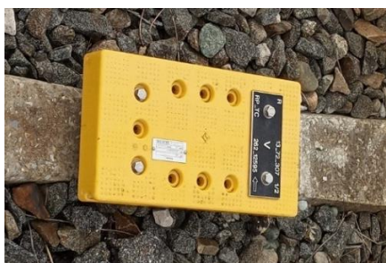
Сурет 2.10 – Пассивті реперлік датчиктің орнатылу принципі
